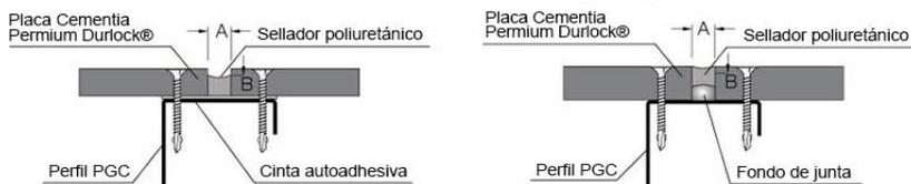
**Aplicación:** instale cinta de enmascarar a los bordes de las placas, con el objeto de delimitar la junta, instale el cordón de fondo y aplique el sellador poliuretánico, verificando que este llene la totalidad de la junta. Rehundir con espátula en el caso que sea necesario
