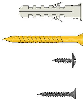
**Tarugos de expansión de nylon N°8**, con tope y **tornillos de acero** de 6mm de diámetro x 40mm. Utilizados para la fijación de perfiles Solera y Montante a piso, losa, hormigón o mampostería.
